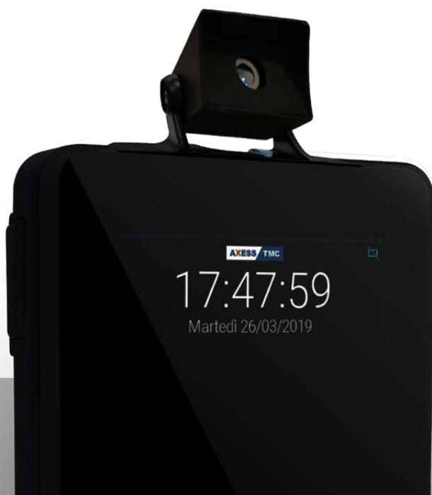
*MITO-03 è una telecamera termica che può essere installata sui terminali Axess TMC.*
